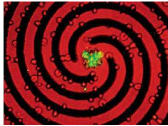
FIGURE 2.6 – Electrodes spiralées – Tri de cellules contaminées par la malaria (au centre en vert), The university of Texas System, Austin, USA, citeBecker99 .
